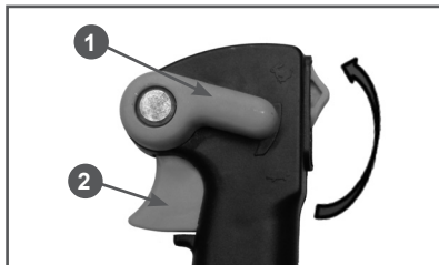
Рис. 12 Фиксатор курка газа и курок газа
