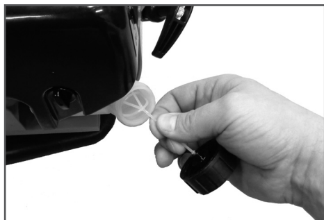
Рис. 14 Снятие крышки топливного бака
