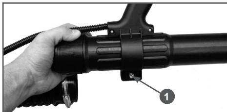
Рис. 4 Установка рукоятки управления
